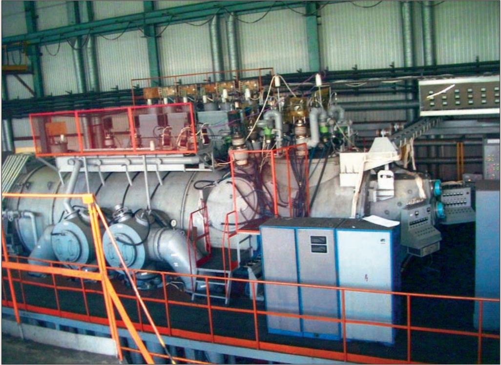
Установка для електронно-променевого переплаву титану на ДЗСЕМ ІЕЗ ім. Є.О. Патона. Установка для електронно-лучевого переплава титана на ОЗСЭМ ІЭС ім. Е.О. Патона.
