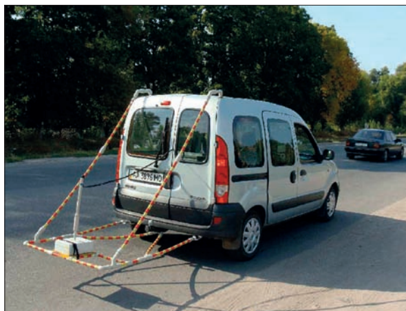
Надиширокопasmовий георадар у складі пересувної лабораторії. Інститут радіофізики та електроніки ім. О. Я. Усикова НАН України
