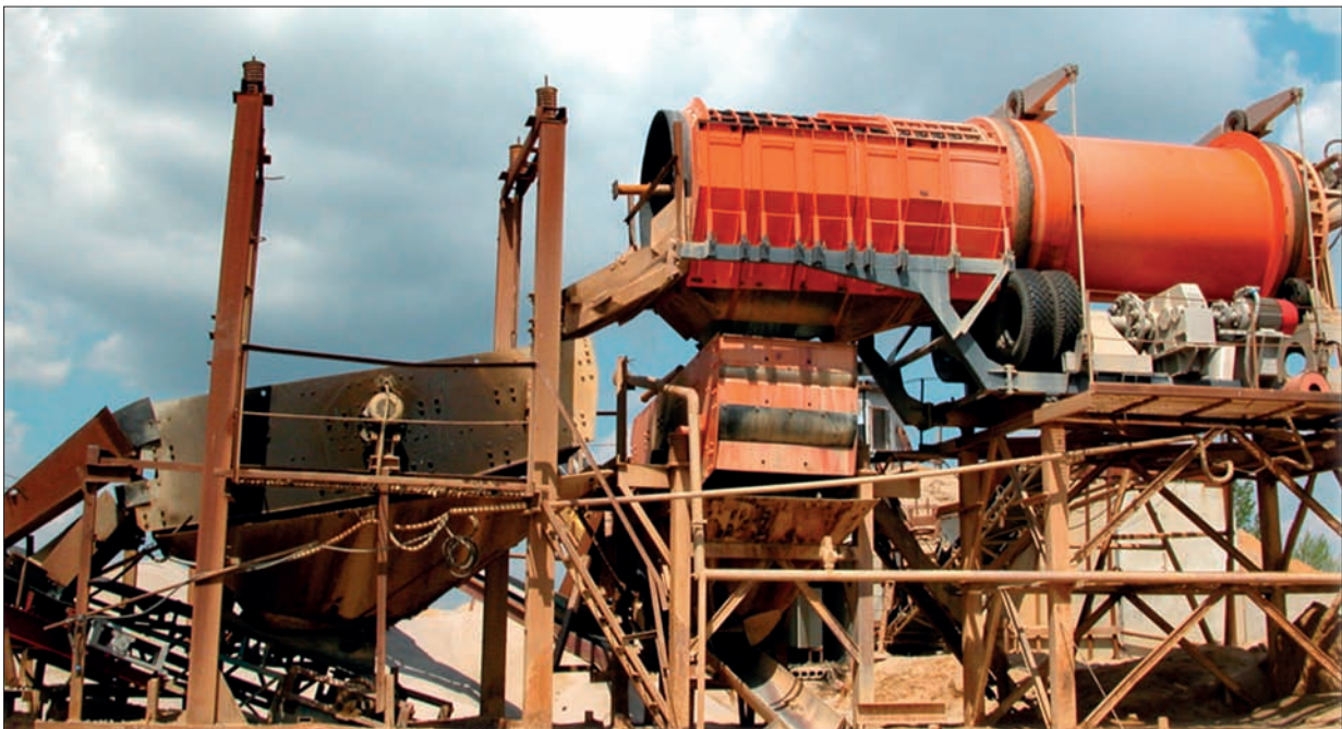
Промивно-сортувальний комплекс для перероблення кварцитів Васильківського родовища з модернізованою скруббер-бутаюрою СБР 100
