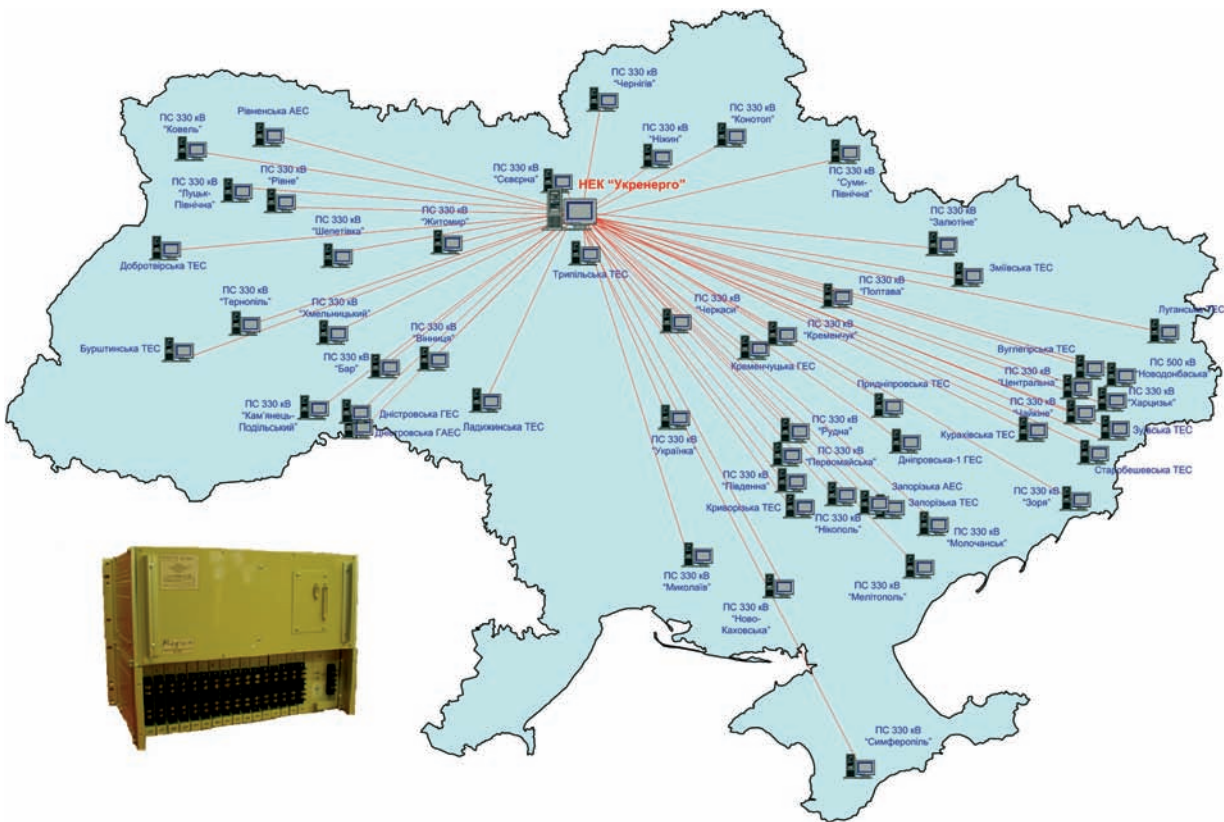
Система синхронізованих вимірювань основних режимних параметрів енергосистеми України. Інститут електродинаміки НАН України
