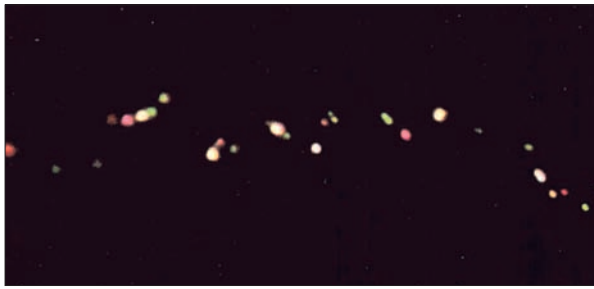
Явище холодної емісії електронів у разі проходження струму через острівцеві металеві плівки. Одна з перших кольорових фотографій електролюмінесценції острівкової плівки золота з поздовжнім розміром 10 мкм
