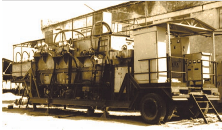
Пересувна установка для біоколідного вилучення золота із ціанідних розчинів «Біоцітан»
