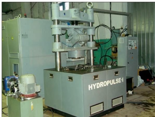
Малогобаритний електрогідравлічний прес для штампування деталей складної форми (800 од./год). Інститут імпульсних процесів і технологій НАН України
