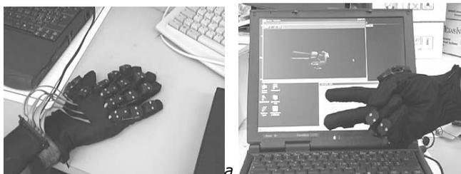
Рисунок 23.8. Электронная сенсорная перчатка для телереабилитации пациентов с последствиями травм и заболеваний кисти, нарушениями двигательных функций: а - общий вид, б - отслеживание движений и создание 3D модели кисти<sup>128</sup>
