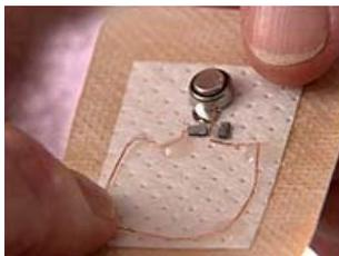
*Рисунок 8.5. Постоянно носимый (на лейкопластыре) минидагчик ЭКГ и система экстренного оповещения<sup>64</sup>*
