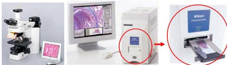
Рисунок 4.14. Роботизированные микроскопы (телепатологические станции)<sup>42</sup>
