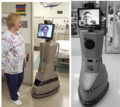
*Рисунок 10.3. Абонентский терминал системы телеприсутствия на роботизированном шасси <sup>73</sup>*
