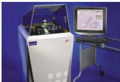
Рисунок 15.4. Автоматический сканер для получения виртуального слайда микропрепарата<sup>86</sup>
