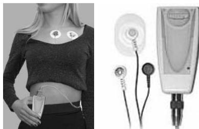
Рисунок 25.2. «Прибор пациента», передающее устройства комплекса радиомониторного ЭКГ-контроля<sup>138</sup>
