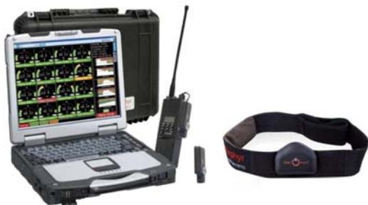
Рисунок 25.3. Военная телеметрическая система: набор датчиков, пояс для крепления датчиков, прибор исследователя (командира) и радиоприемное устройство. На экране графически отражается состояние физиологических функций каждого мониторируемого военнослужащего<sup>139</sup>
