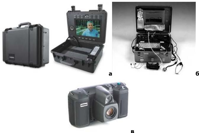
Рисунок 6.18. Портативный комплексы для видеоконференц-связи в экстремальных условиях: а-кейс, б - кейс со встроенным набором диагностических устройств, в – комплекс-камера<sup>54</sup>
