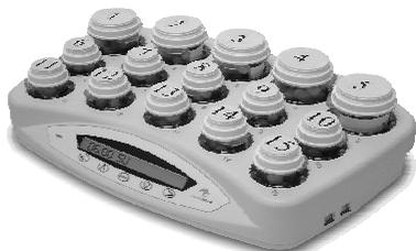
*Рисунок 8.4. Прибор для управления (медикаменты рассортированы по контейнерам; согласно программе прибор извещает пациента о необходимости приема нужного количества таблеток из нужного контейнера) и контроля (если пациент многократно пропустил прием медикаментов прибор автоматически извещает call-центр о возможной недееспособности подопечного)<sup>63</sup>*
