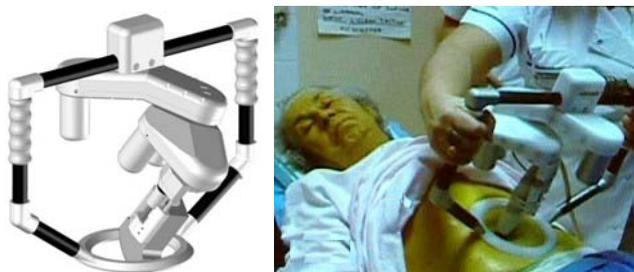
*Рисунок 4.12. Роботизированный прибор для дистанционного проведения ультразвуковых исследований<sup>41</sup>*
