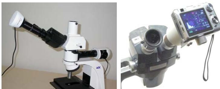
Рисунок 4.3. Микроскоп со специальной цифровой камерой и микроскоп с C-креплением для цифровой фотокамеры<sup>31</sup>
