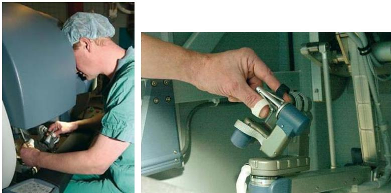
*Рисунок 10.9. Master-компонент (хирургическая консоль) активной инвазивной (телехирургической) системы телеассистирования<sup>80</sup>*
