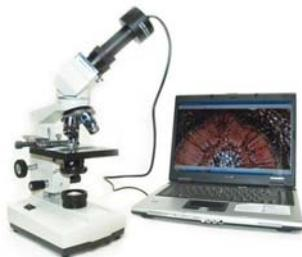
*Рисунок 15.2. Система для статической телепатологии (микроскоп со специальной камерой)<sup>85</sup>*
