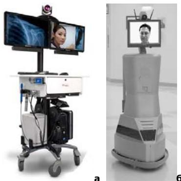
Рисунок 6.17. Мобильные комплексы для видеоконференц-связи: а - передвижная станция, б - передвижная станция на роботизированном шасси<sup>53</sup>
