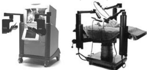
Рисунок 4.15. Телехирургическая установка для дистанционных эндоскопических операций<sup>43</sup>
