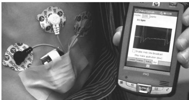
Рисунок 7.4. Беспроводная биотелеметрическая система (компонент домашней, индивидуальной телемедицины)<sup>61</sup>
